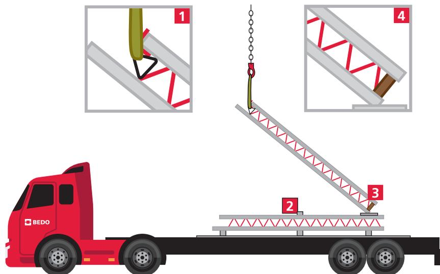
Reduzierung der Anschlagpunkte nur in Abstimmung mit dem Fertigteilwerk.
