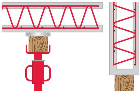
Wandschlitz/Wandaussparungen (Holz bzw. Styropor) gegen Betonierdruck sichern.
