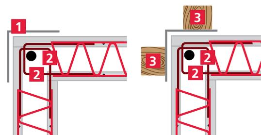
Eck- und Stoßbereich der Doppelwände gegen Betonierdruck sichern
