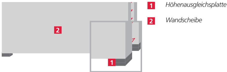
Bei der Thermowand darf nur die rauminnenseitige Betonschale/Wandschale unterlegt werden, die mit Dämmung versehene Betonschale **nicht unterlegen**.
