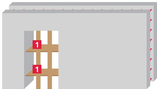
Türzargen gegen Betonierdruck durch Einlegebretter sichern. Eingebaute FH-Türen unbedingt vor Betonieren schließen!
